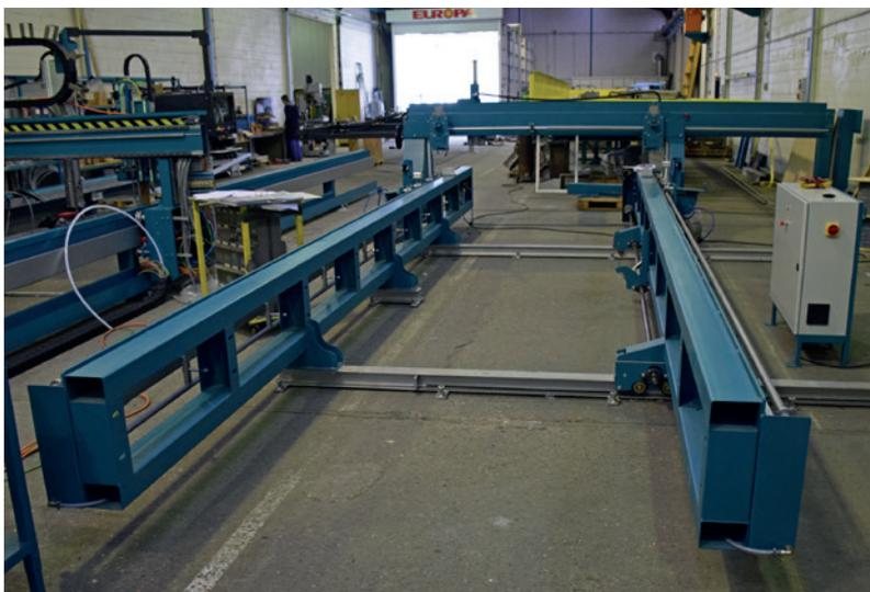
La nouvelle M4 est une table entièrement manuelle et pneumatique, montée sur des poutres métalliques. Simple et ergonomique, elle permet de fabriquer des ossatures bois contreventées pour un budget minimum.
