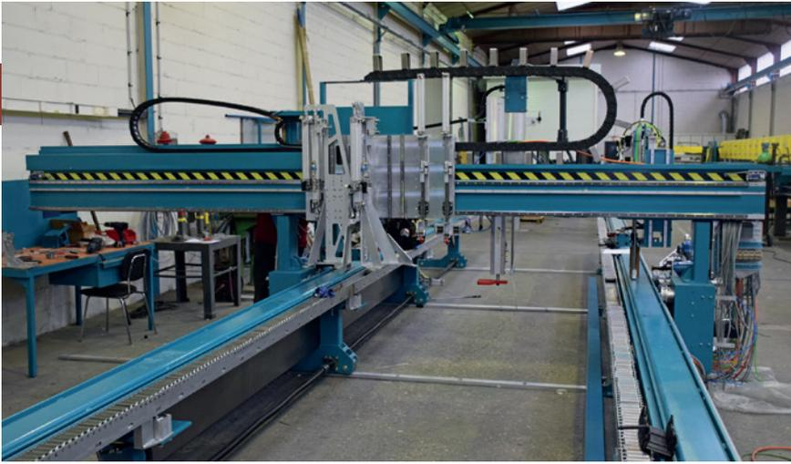
◀ **La V4 nouvelle version est une table d'assemblage numérique qui inclut pour la première fois une fonction de défonçage des panneaux de contreventement, élargissant ses domaines d'application.**
