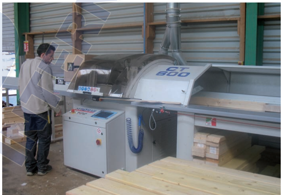
Cette scie radiale numérique Stromab CT600, munie d'une lame en carbure Widia d'un diamètre de 600 mm, découpe les pièces d'ossature bois.
