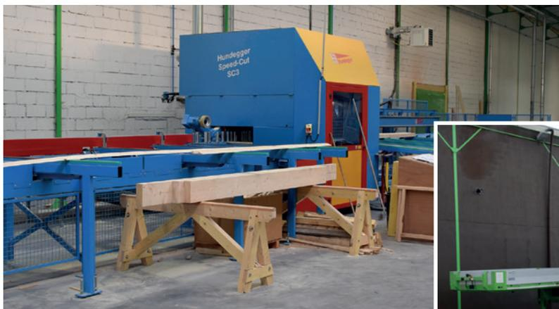
En amont et en aval, B-Logik a aussi fait le choix de la qualité avec une Speed-Cut SC3 Hundegger pour le débit et le système de transport, de protection et de stockage d'Auwaerter.
