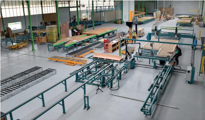
◀ **Vue d'ensemble de l'atelier structure, équipé de A à Z par Mach Diffusion avec au premier plan la table d'assemblage V5 et les cinq postes de travail desservis par le transbordeur en sortie de table. Au fond à gauche les murs sont maintenus verticaux et enduits, tandis qu'à droite un système plongeant permet de réaliser le bardage à hauteur d'homme.**
