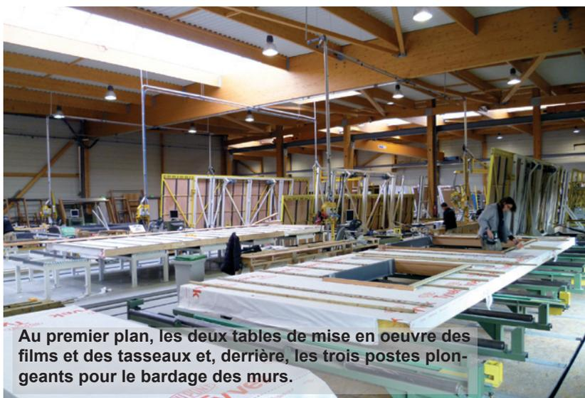
Au premier plan, les deux tables de mise en oeuvre des films et des tasseaux et, derrière, les trois postes plongeants pour le bardage des murs.
