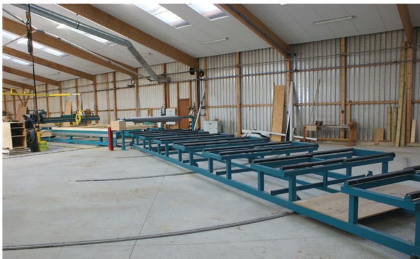
◀ Le système de convoyage pivotant en sortie de table d'assemblage permet d'alimenter deux postes de bardage plongeants verticaux. Tous les systèmes de transport de l'atelier sont fixés sur rails. Cette organisation de la production a été mise en place en faisant appel à Daniel Costiou, spécialisé dans le conseil en gestion de production.
