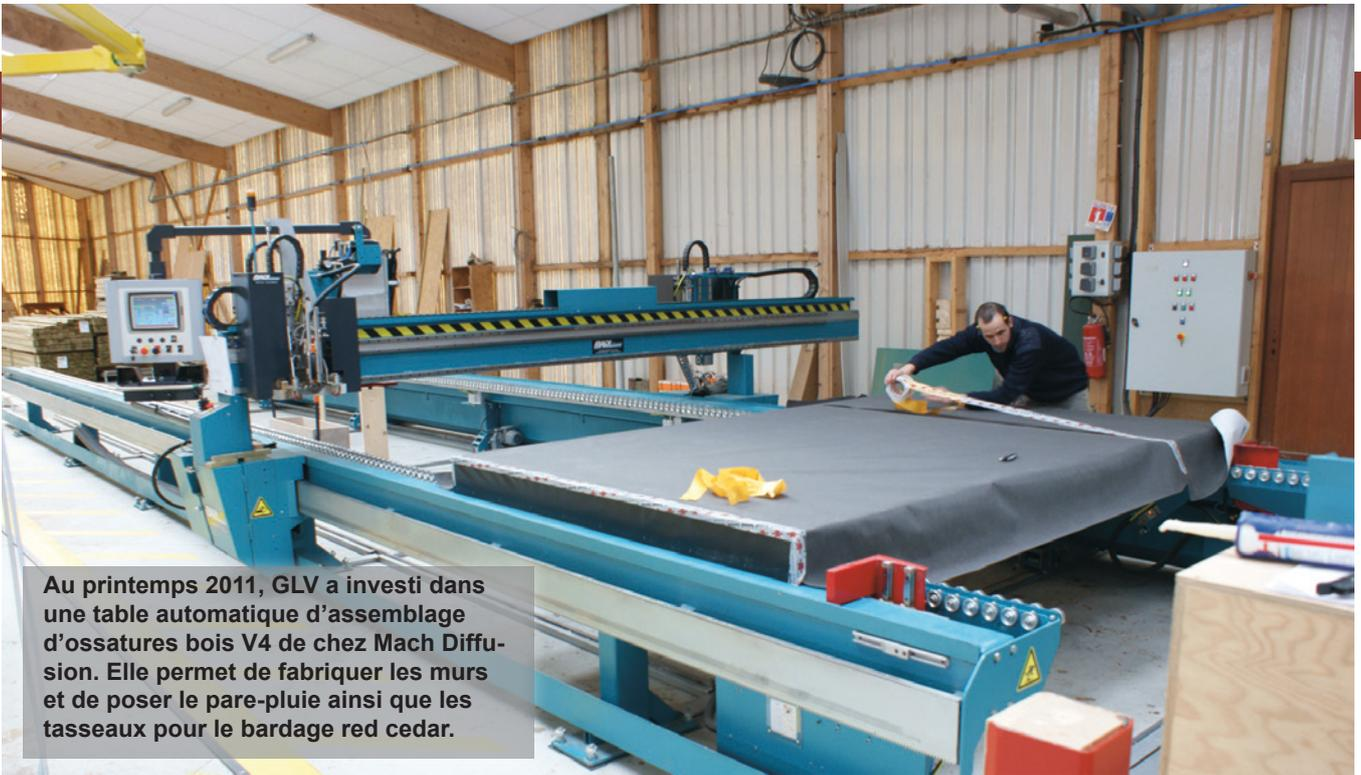
**Au printemps 2011, GLV a investi dans une table automatique d'assemblage d'ossatures bois V4 de chez Mach Diffusion. Elle permet de fabriquer les murs et de poser le pare-pluie ainsi que les tasseaux pour le bardage red cedar.**
