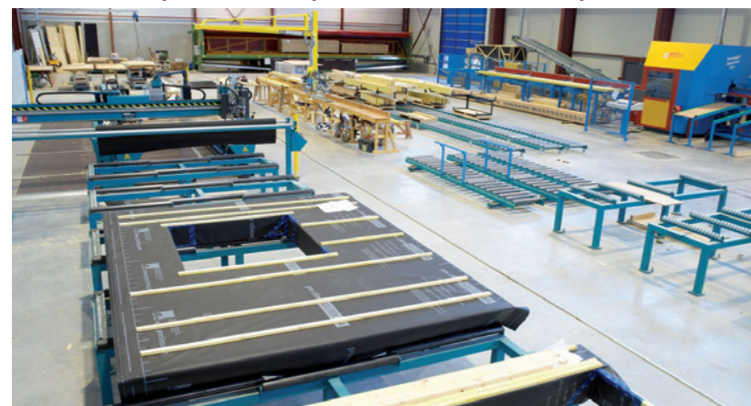
L'atelier avec au premier plan, la table d'assemblage de murs Mach V4 et à droite la Speed-Cut SC3 pour les montants et charpentés.
