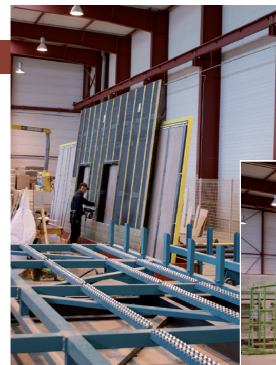
Le poste de bardage plongeant avec, au premier plan, la table papillon, tous deux conçus par Mach Diffusion. Un exemple des murs produits par le Bâtiment Associé.
